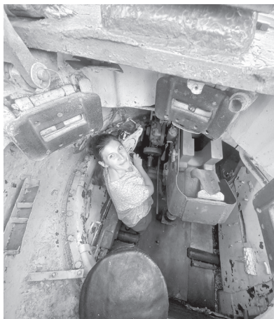
Рис. 1. Боевое отделение танка Т-34-85 после проведения первичной очистки поверхностей. 2021 г.
